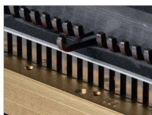
Outils de perforation avec poinçons débrayables (QSA).
