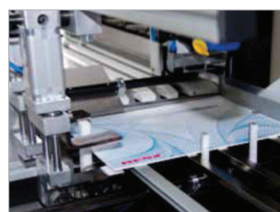
Station d'accumulation des liasses perforées avant reliure.
